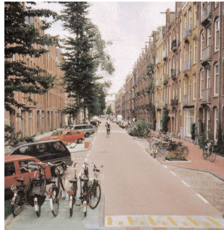
▲ Une rue d'une zone 30 dans un quartier très dense d'Amsterdam. La suite de dos d'ânes allongés assure une vitesse adéquate de la circulation automobile. L'ambiance de la rue invite au partage de l'espace.
